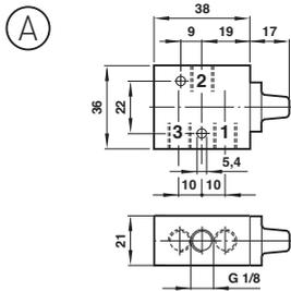
G1/4, 3/2 Пружинный возврат, базовый корпус
