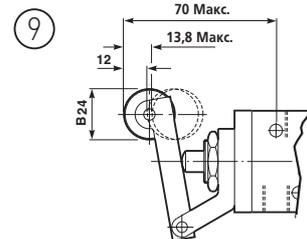
Роликовый рычаг для тяжелых условий – G1/8 распределители
