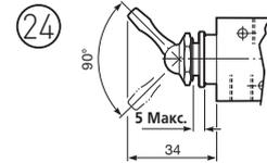
Распределитель с рычажным управлением, пружинный возврат – G1/8 распределители
