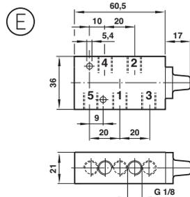
G1/4, 5/2 Пружинный возврат, базовый корпус
