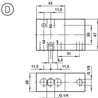
G1/8, 5/2 Пружинный возврат, базовый корпус
