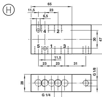
G1/4, 5/3 Пружинный возврат, базовый корпус
