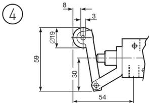
Чувствительный роликовый рычаг – G1/8 распределители
