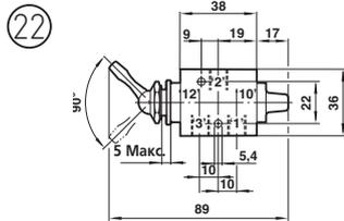
Распределитель с рычажным управлением, пружинный возврат – G1/8 распределители
