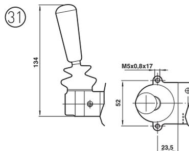
Рычаг/пружина/рычаг – G1/4 распределители
